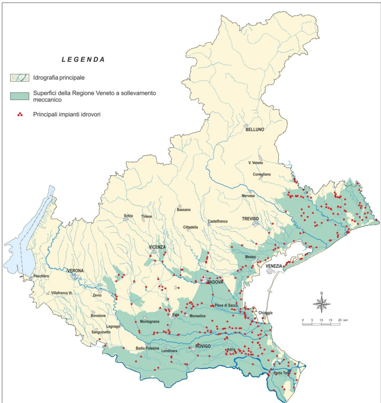
Figura 75: Superfici a sollevamento meccanico e principali impianti idrovori nella Regione Veneto (Fonte: Università di Padova, Dipartimento di Ingegneria Civile, Edile e Ambientale DICEA)
